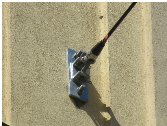
Obr. 18: Horizontální kardan s parafilem
